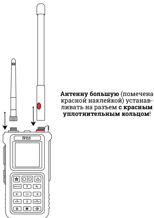
Рис. 4. Установка антенн на детектор
