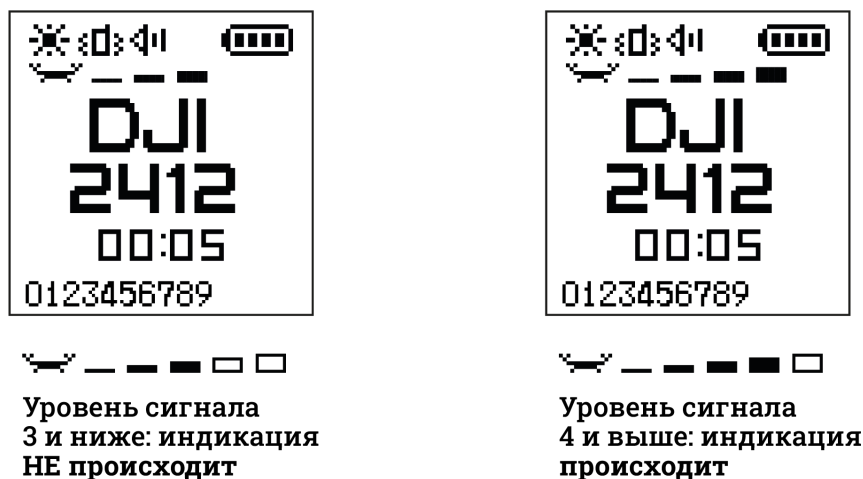
Рис. 23. Принцип детекции при настройке порога RSSI
